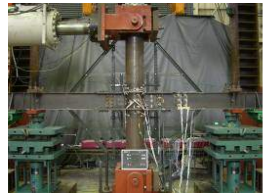
柱梁接合部実験
