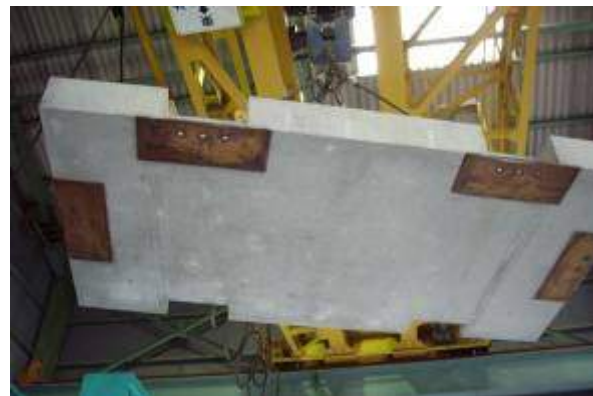
再利用可能床板接合部実験
