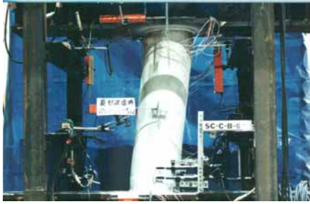
写真 2-1 CFT造柱の軸力・曲げせん断実験
