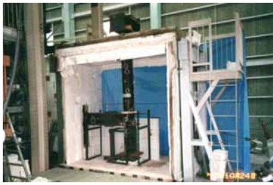
写真 3-1 複合載荷耐火実験
