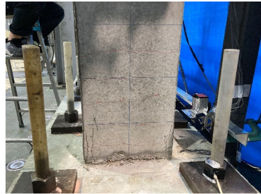
(h) R=20 \times 10^{-3} rad 右柱圧壊 (側面よ)
