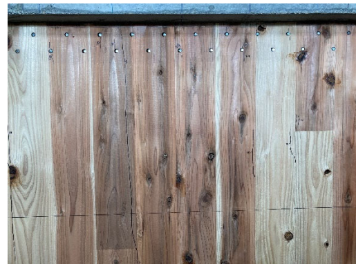
(f) R=10 \times 10^{-3} rad CLT せん断破壊
