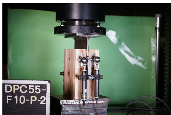
写真 2.11 圧縮試験加力状況
