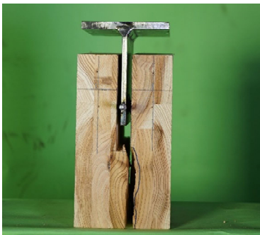
写真 2.12 単位接合部圧縮試験損傷状況 (強度等級 S60-5-5, DPφ10)
