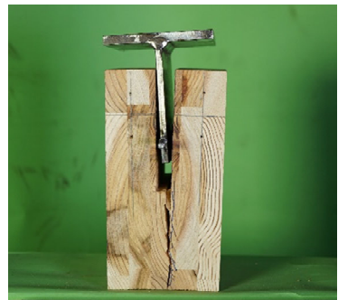
写真 2.12 単位接合部圧縮試験損傷状況 (強度等級 S60-5-5, DPφ10)
