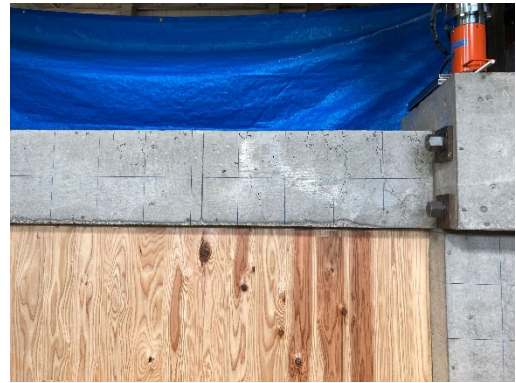
(d) R=5.0 \times 10^{-3} rad 梁右ひび割れ状況
