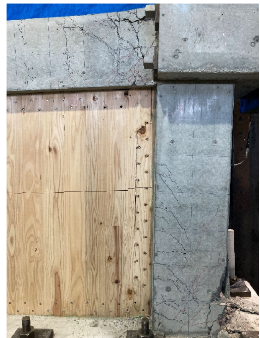
(l) R=50 \times 10^{-3} \text{rad} 鉛直鋼板挿入部 CLT 破断
