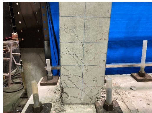
(l) R=58 \times 10^{-3} rad 左柱ひび割れ状況
