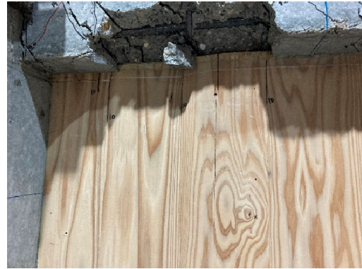
(j) R=33 \times 10^{-3} \text{rad} (2回目) CLT 壁左上面外座屈
