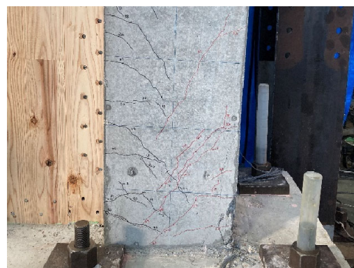
(h) R=20 \times 10^{-3} rad RC 柱圧壊
