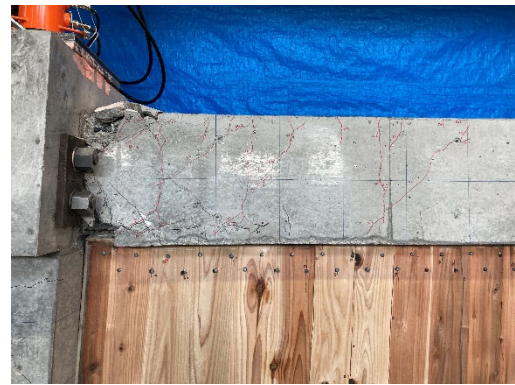
(l) R=51 \times 10^{-3} rad CLT 壁左上部拡大
