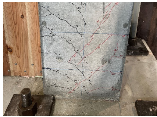
(h) R=20 \times 10^{-3} rad RC 柱圧壊
