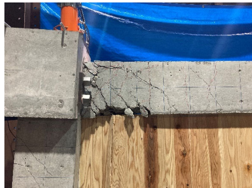
(l) R=52 \times 10^{-3} \text{rad} CLT 壁左上面外座屈
