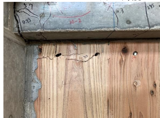
(h) R=20 \times 10^{-3} rad CLT 一部圧壊
