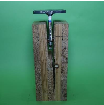
写真 2.9 単位接合部圧縮試験損傷状況 (強度等級 S60-5-5, DPφ12)
