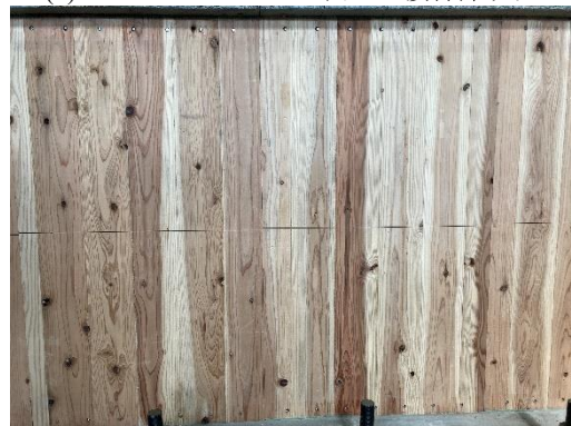
(f) R=10 \times 10^{-3} \text{rad} CLT 版ロック変形
