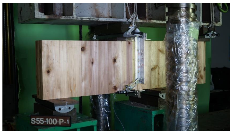
写真 2.1 せん断試験加力状況
