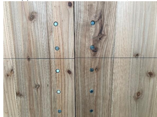
(d) R=5.0 \times 10^{-3} rad CLT 同士の接合部ずれ状況
