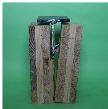
写真 2.11 単位接合部圧縮試験損傷状況 (強度等級 S60-7-7, DPφ16)
