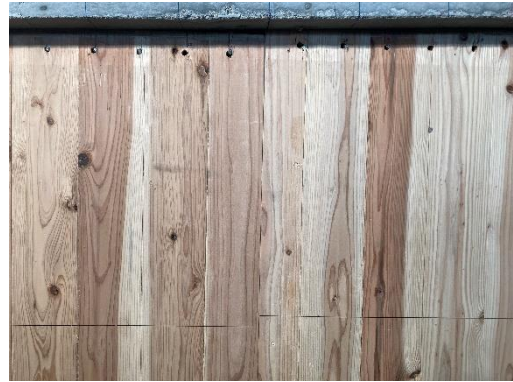
(j) R=33 \times 10^{-3} \text{rad} CLT 同士のずれ・DP 損傷状況
