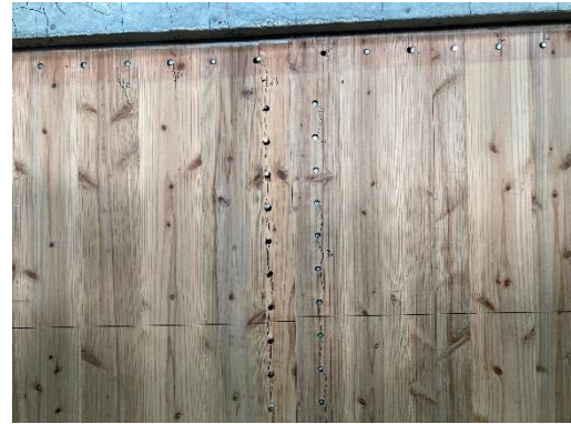
(j) R=33 \times 10^{-3} rad DP 接合部集合型破壊
