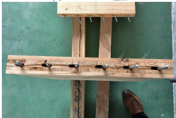
(m) 実験終了後 ダボ接合部の損傷部
