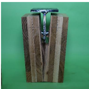
写真 2.11 単位接合部圧縮試験損傷状況 (強度等級 S60-7-7, DPφ16)
