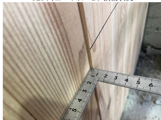
(l) R=50 \times 10^{-3} \text{rad} CLT の面外ずれ
