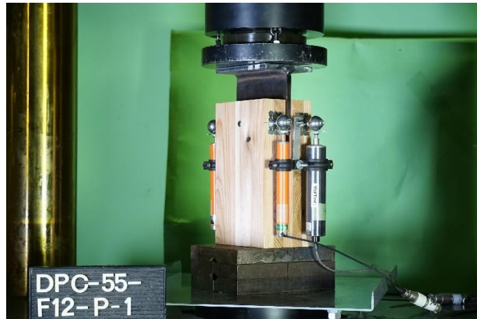
写真 2.7 圧縮試験加力状況
