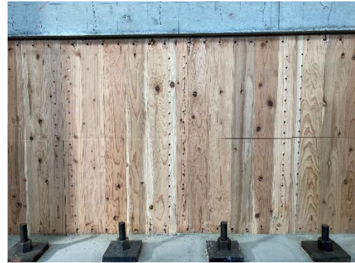
(j) R=33 \times 10^{-3} rad CLT 同士の接合部集合型破壊
